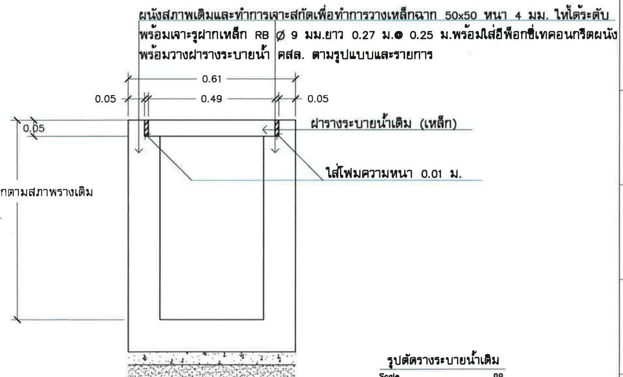
แปลนฝารางระบายน้ำความกว้างภายในเฉลี่ย 0.40 เมตร(หรือเฉลี่ยตามสภาพพื้นที่) Scale 1:15
